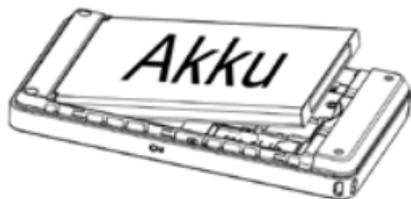
Öffnen Sie die untere Geräteabdeckung indem Sie den Deckel aufschieben und heben Sie den Akku, wie dargestellt, aus dem Gerät heraus.
